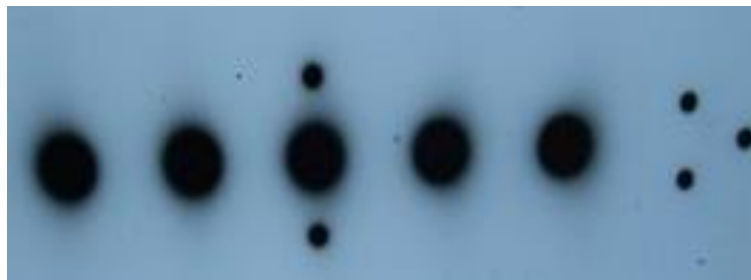
Gambar 15. Hasil Gambar Radiograf Grid Alignment Test Tool Dengan Faktor Eksposi 80 kV, dan 12,6 mAs
