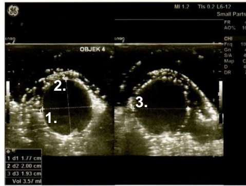
Gambar 3 Contoh Pengukuran Volume pada Prototype dengan menggunakan alat USG; 1. Pengukuran Diameter Transversal , 2. Pengukuran Diameter Longitudinal , 3. Pengukuran Diameter Anteroposterior
