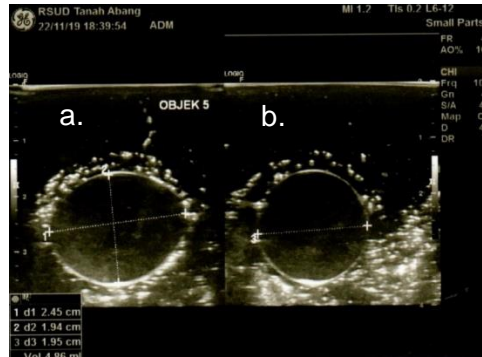
Gambar 2 Contoh Gambar Hasil Scan Prototype Volume dengan menggunakan alat USG; a. hasil scan Transversal , b. Hasil scan Longitudinal
