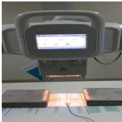
Gambar 4. Pengambilan Intensitas Radiasi Tanpa Penahan
