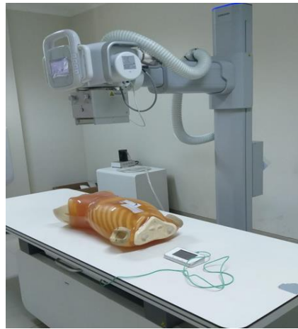
Gambar 1 Pengukuran dosis dengan letak katoda pada bagian proksimal
