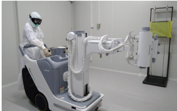
Gambar 10 Mobile X-ray dan Kaset yang sudah dilapisi plastik khusus Bagaimana Radiografer kontak dengan pasien?
